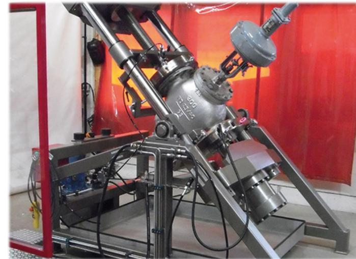
Sistema de sujeción TSHV 30-S con válvula en posición inclinada
