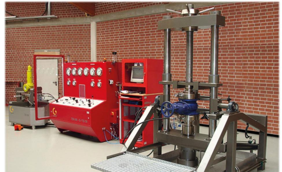
Sistema de sujeción TSHV 30-S con válvula en posición horizontal
