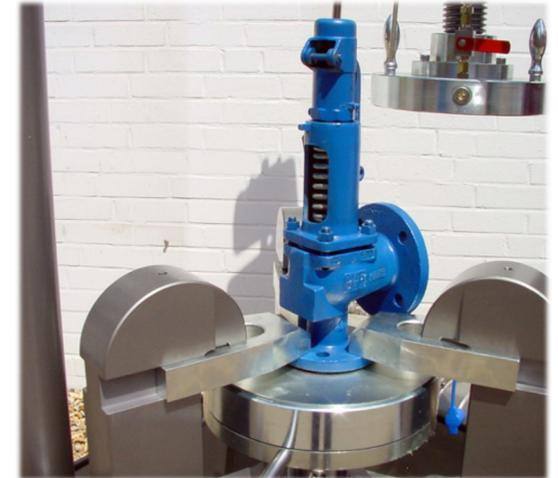
Detalle del sistema de fijación
