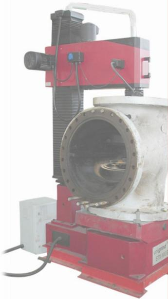
La gama de equipos portátiles fabricados por Unigrind, permite afrontar con garantías de pleno éxito, reparaciones mecánicas o acciones de mantenimiento correctivo en válvulas industriales.
